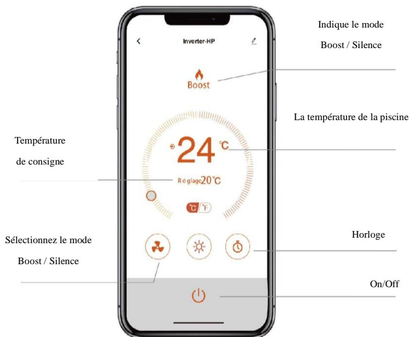
2. Pour les pompes à chaleur avec mode chauffage/refroidissement :
